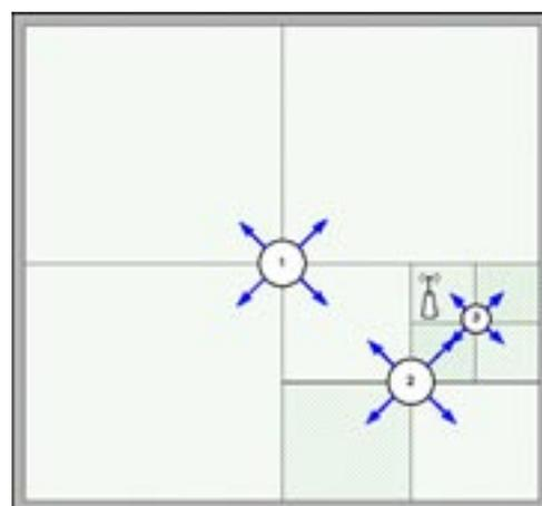
**Рисунок 8** Схема поиска векторным методом
