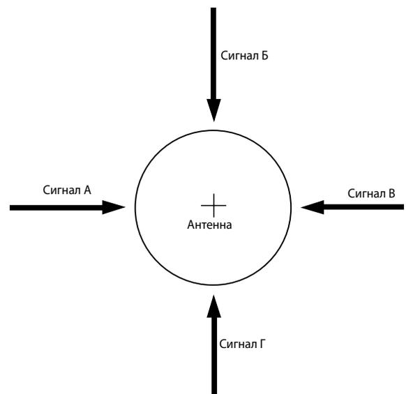
Рисунок 1 Схема действия антенны с круговой диаграммой направленности
