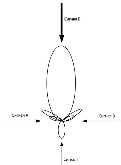
**Рисунок 6** Схема действия направленной антенны
