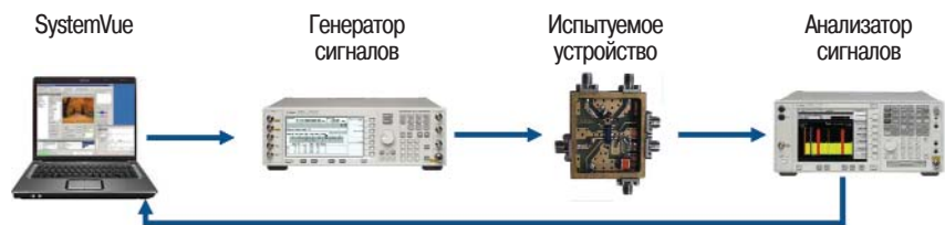
Рисунок 16 – Комбинация программных средств и измерительных приборов может быть использована для создания и генерации испытательных сигналов РЛС
