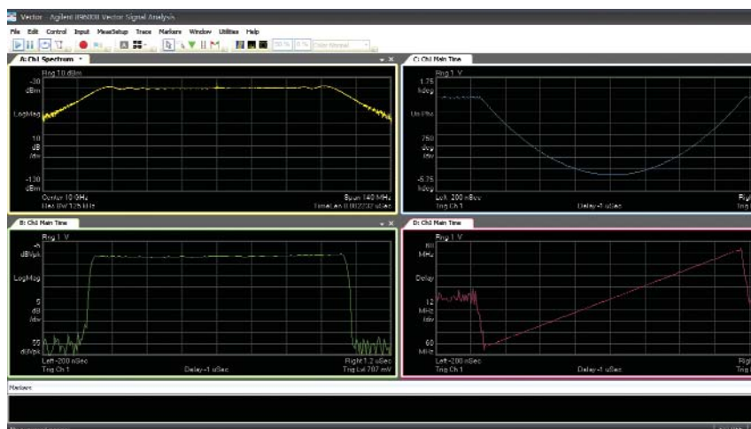
Рисунок 18 – Просмотр ЛЧМ-импульса с помощью ПО 89601B VSA
