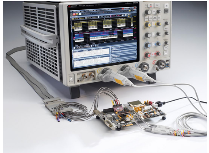
Тестирование памяти DDR3 с помощью осциллографа смешанных сигналов.
