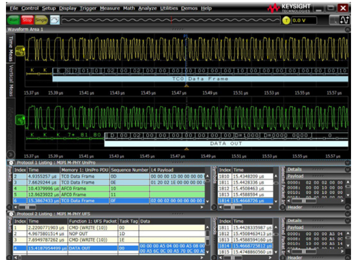
Декодирование пакета и проверка CRC с помощью декодеров осциллографа для протоколов MIPI UniPro и UFS.
