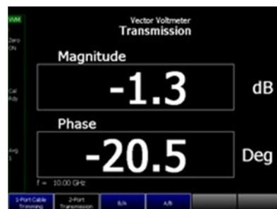
Балансировка кабелей с помощью векторного вольтметра
