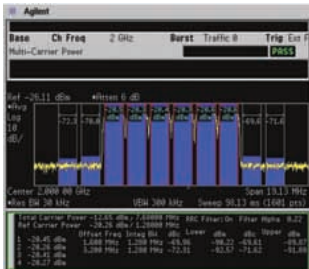
Коэффициент утечки мощности в соседний канал (ACLR) сигнала TD-SCDMA с 6 несущими на линии “вниз”.
