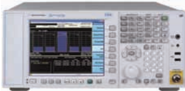
Анализатор сигналов СХА компании Agilent является универсальным и недорогим средством измерения важнейших параметров сигнала
