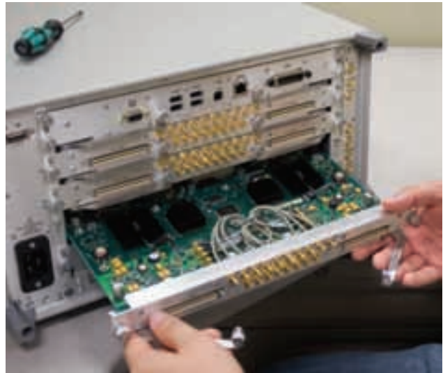
Возможность быстрой модернизации на месте эксплуатации, которая не требует калибровки
