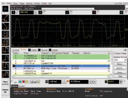
Запуск и декодирование пакетов последовательной шины PCIe
