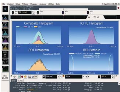
Анализ джиттера плюс выделение RJ/DJ
