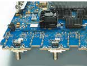
Маломощные входные каскады и корректирующие фильтры обеспечивают равномерную частотную характеристику
