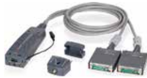
Двухканальный датчик тока CX1102A (поставляется с CX1203A)
