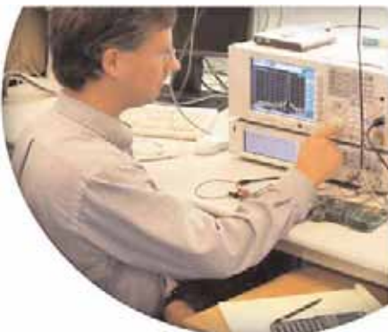
Генератор серии MXG и анализатор серии MXA компании Agilent - комплексное техническое решение для испытаний компонентов и приемников беспроводных сетей.
