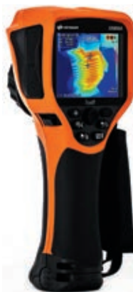
Отладка электронных схем с помощью U5855A
