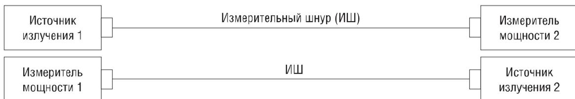
Определение контрольного уровня оптической мощности
