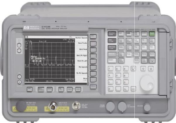
ESA-L имеет высокую скорость самотестирования и 5-минут на разогрев и выход на гарантированные параметры работы. Кроме того, автоматическая защита перегрузки входа позволяет избежать дорогостоящего ремонта, а компоновка модулей уменьшает вероятность выхода прибора из строя. Выключатель мгновенного действия на коробке аккумуляторов, обеспечивающих постоянное напряжение в 12В, позволяют использовать анализатор без подключения к электрической сети.
