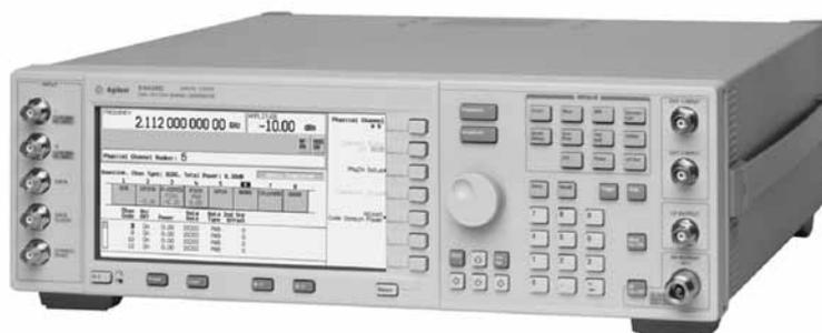
Векторный генератор сигналов E4438C серии ESG (от 250 кГц до 6 ГГц)
