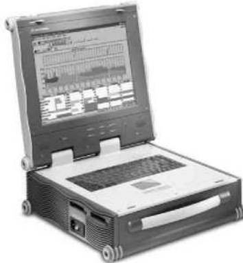
Анализатор J6800A Network Analyzer представляет собой портативное "все-в-одном" решение, которое включает в себя две синхронизированных по времени системы сбора данных, поддерживающие любые подключаемые модули сопряжения (LIM) с LAN или WAN.
