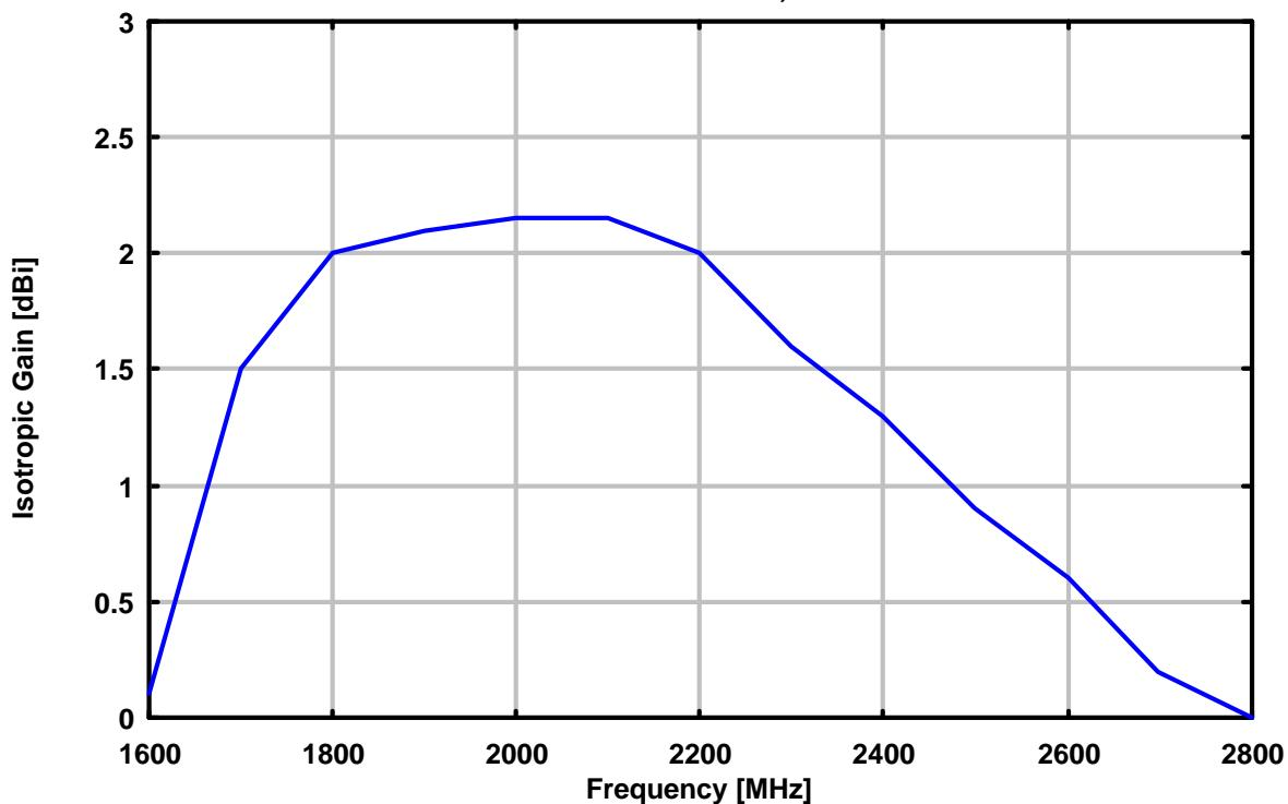
Antennenwandlungsmaß, Elementlänge 72 mm, Kurzschlußschieber 36 mm
