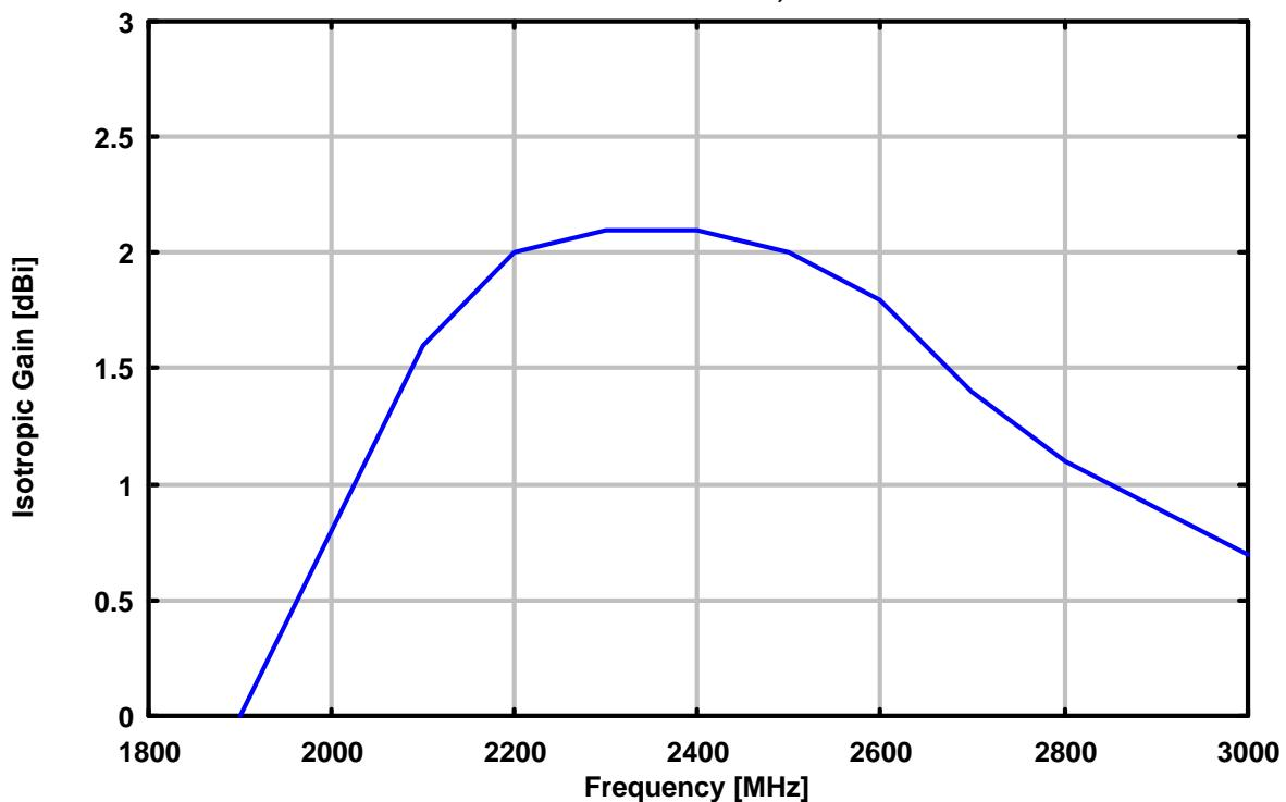
Antennenwandlungsmaß, Elementlänge 60 mm, Kurzschlußschieber 30 mm
