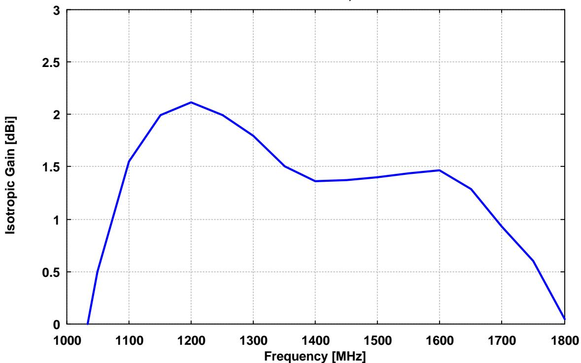
Antennenwandlungsmaß, Elementlänge 114 mm, Kurzschlußschieber entfernt
