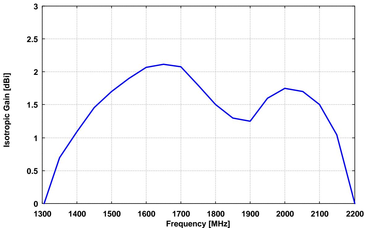
Antennenwandlungsmaß, Elementlänge 90 mm, Kurzschlußschieber 45 mm
