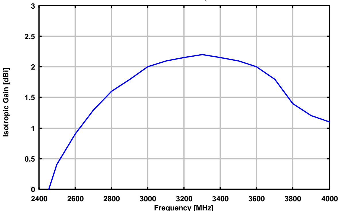
Antennenwandlungsmaß, Elementlänge 48 mm, Kurzschlußschieber 24 mm
