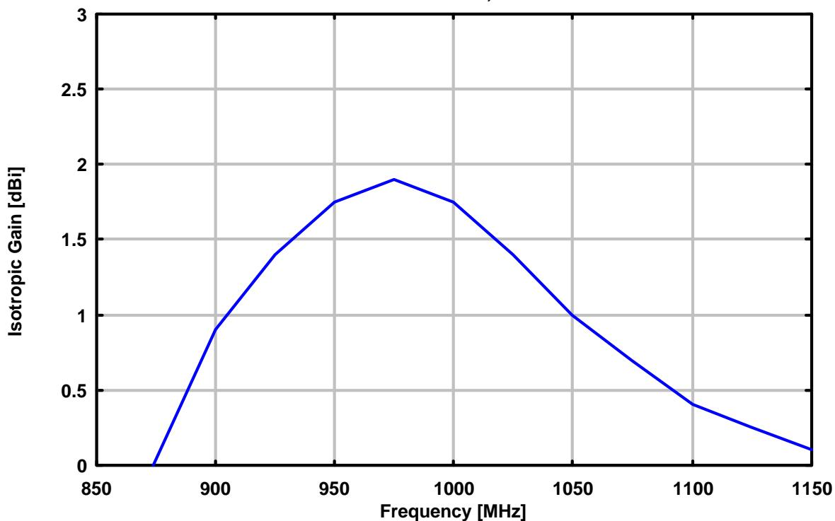
Antennenwandlungsmaß, Elementlänge 140 mm, Kurzschlußschieber entfernt
