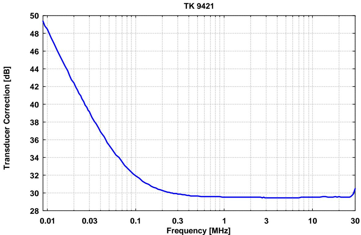
Zur Anzeige eines Meßempfängers mit 50  $\Omega$  Eingang und dB $\mu$ V-Kalibrierung wird im Frequenzbereich 150 kHz - 30 MHz der feste Korrekturwert von 30 dB zur Ablesung hinzugezählt. Das Ergebnis ist die HF-Spannung in dB $\mu$ V an 1.5 k $\Omega$ . Bei Meßfrequenzen unter ca. 150 kHz sind die dB-Korrekturen des obigen Diagramms (statt 30 dB) hinzuzuzählen.
