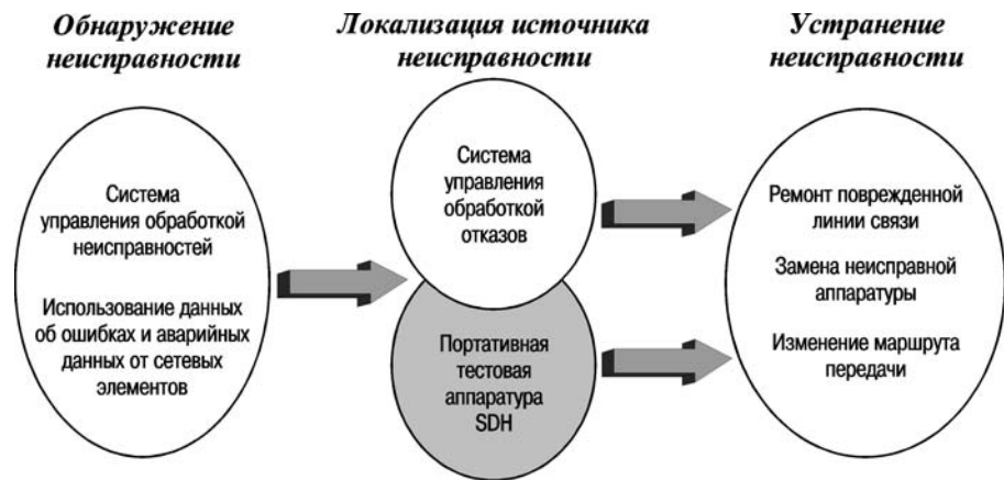
Рис. 1.12. Обслуживание сети SDH
