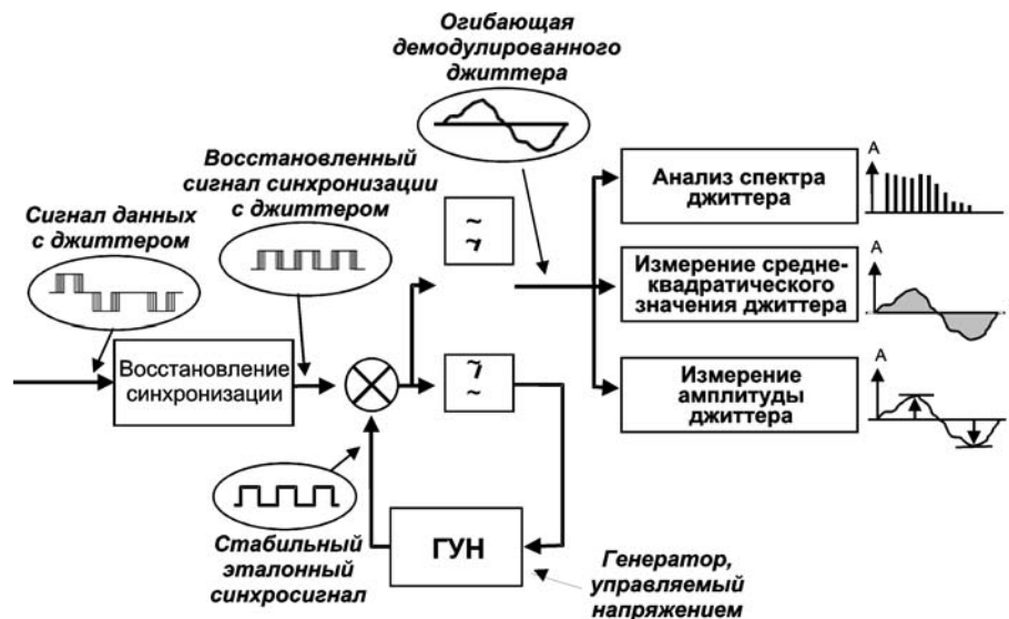
Рис. А-5.1. Измерение джиттера
