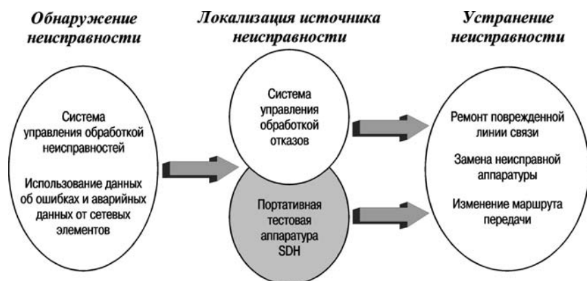
Рис. 1.1. Порядок обслуживания сети SDH
