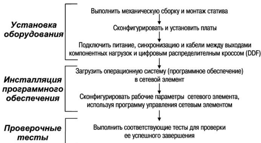
Рис. 2.5. Упрощенная процедура инсталляции сети SDN
