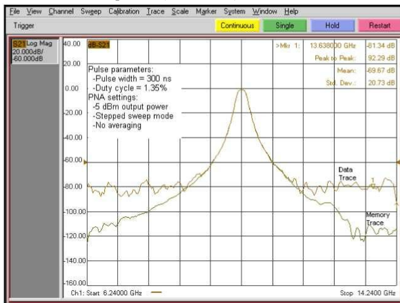
Рис 13 – Режим спектрального обнуления с шириной импульса 300 мкс, скважностью 1.35% , без усреднения
