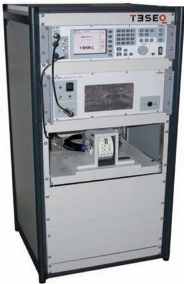
Применение для испытаний на ввод объемного тока (автомобильная промышленность), схема для калибровки (потребная мощность и диапазон частот диктуют необходимость во внешнем усилителе мощности и направленном ответвителе)
