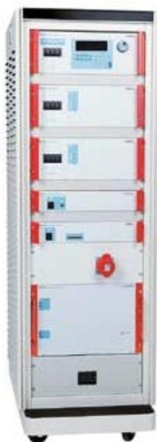
**Полнофункциональная система 3x5 кВА для измерения содержания гармонических составляющих тока и фликера с возможностью испытания качества трехфазного электропитания**
