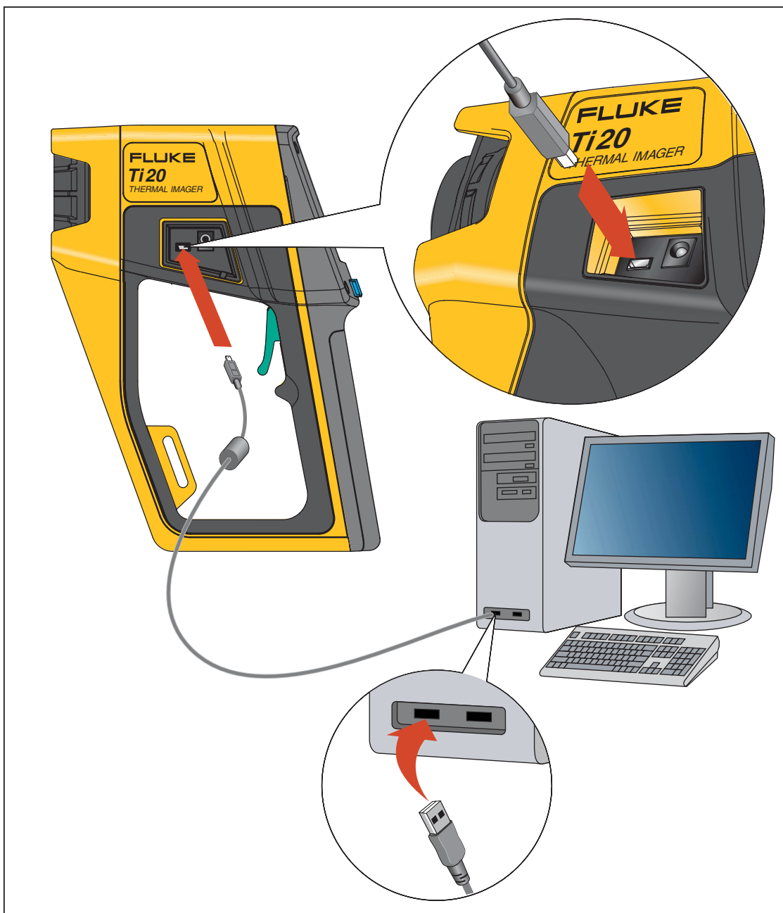
Рисунок 1-9. Подключение с помощью кабеля USB
