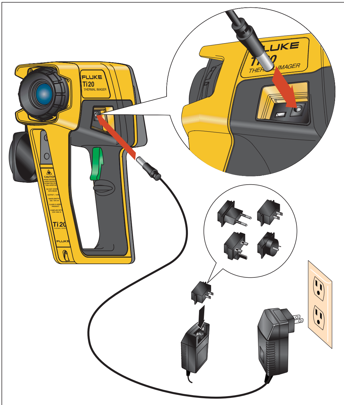
Рисунок 1-5. Использование адаптера источника питания переменного тока
