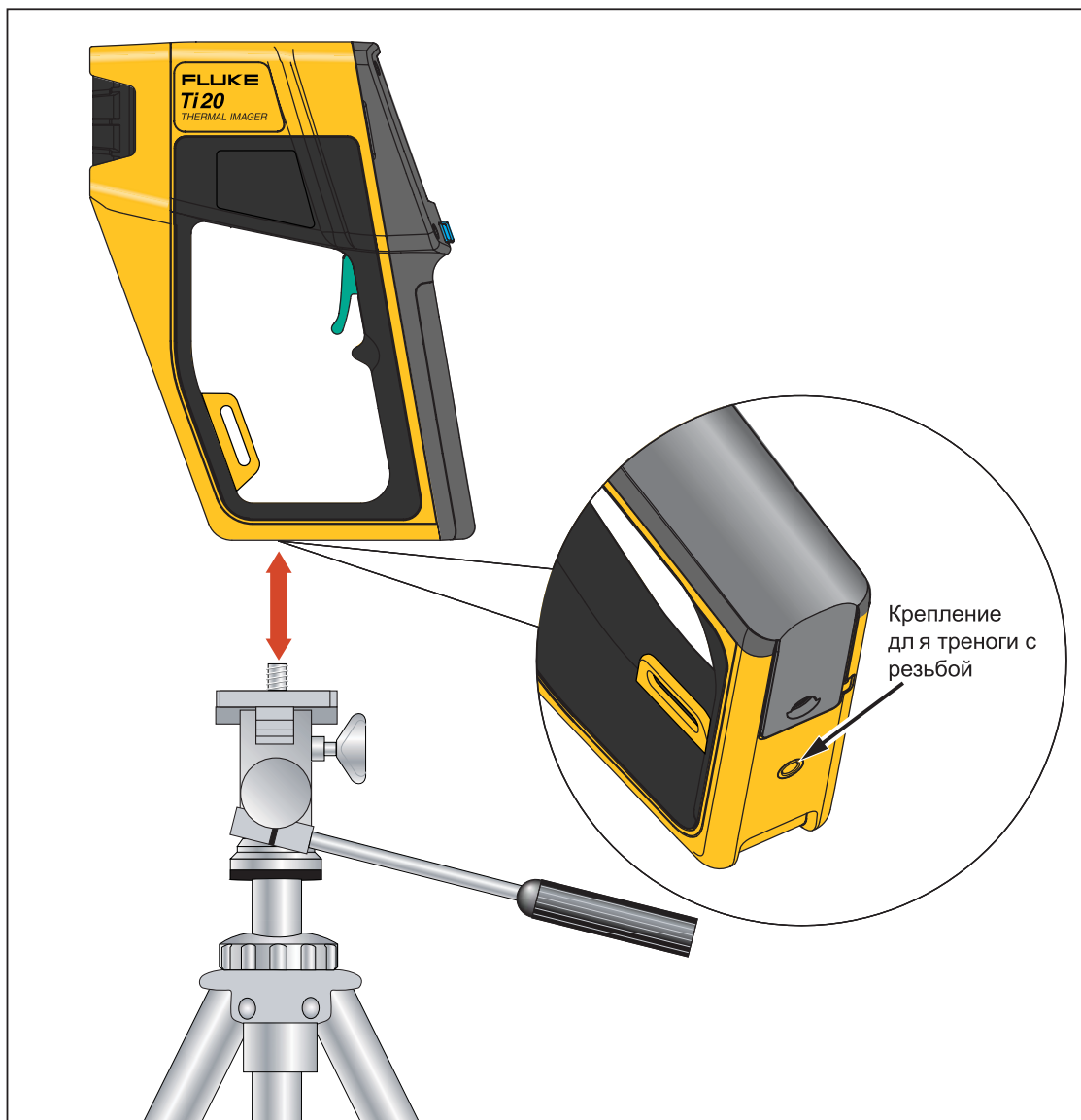
Рисунок 1-10. Крепление тепловизора на треноге
