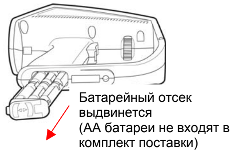
Рис. 1. Замена портативного батарейного источника питания
