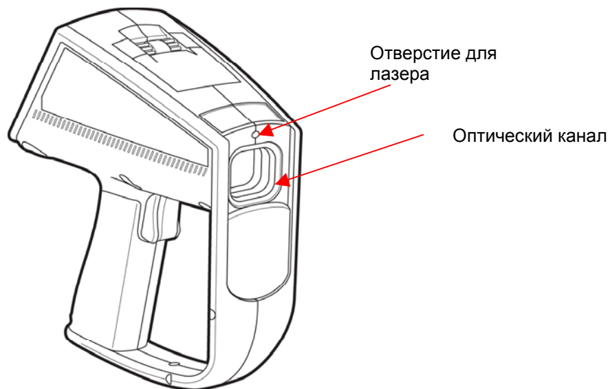
Рис. 12. Отверстие для лазера и оптический канал
