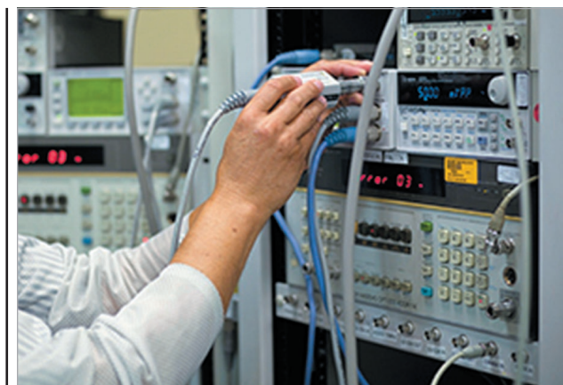
Рис. 1. Встановлення цифрового мультиметра у виробничу випробувальну систему
