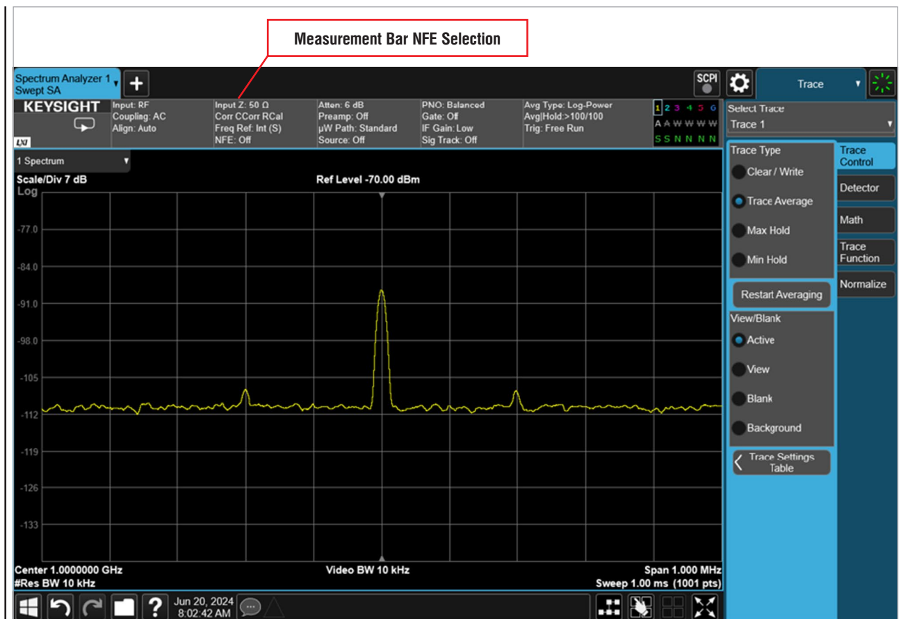
Рис. 3. Рисунок 3. Початок використання функції NFE: натисніть на третій заголовок меню на панелі вимірювань у верхній частині екрана
