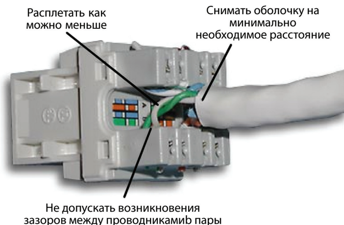
Рисунок 8: Пример правильно выполненного монтажа: пары расплетены на минимальное расстояние, необходимое для заделки.
