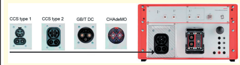
Рис. 3. Система Scienlab Charging Discovery System — портативна серія з різними стандартами зарядки
