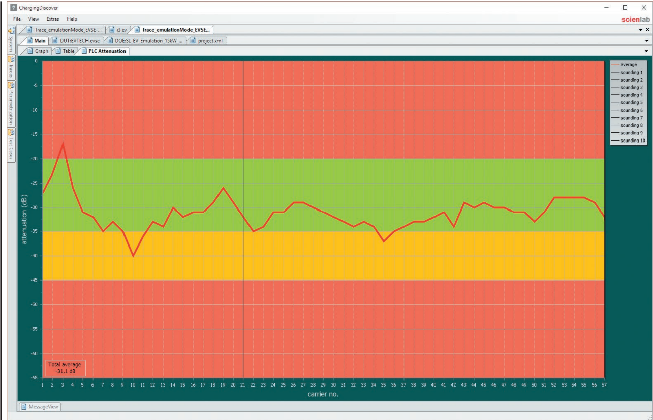
Рис. 6. Аналіз загасання сигналу в лінії електропередачі
